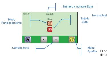
El control en el receptor V25 le permite ser ajustado directamente (On/Off, Temporizador de 2 horas) y éste tendrá prioridad sobre las instrucciones de la unidad
