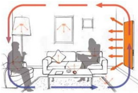
Convección Calentamiento del aire
